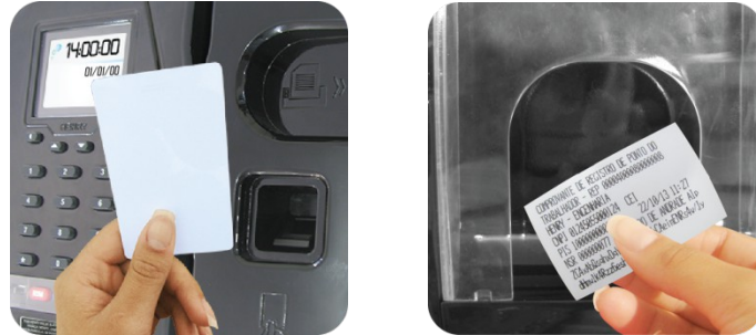
Figura 4 - Marcação de ponto via cartão proximidade RFID.
